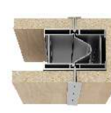
MAW110 POŁĄCZENIE WĘZŁA STARTOWEGO Z PANELEM
