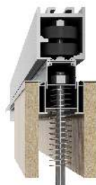
MAW110 POŁĄCZENIE WĘZŁA KOŃCOWEGO Z PANELEM
